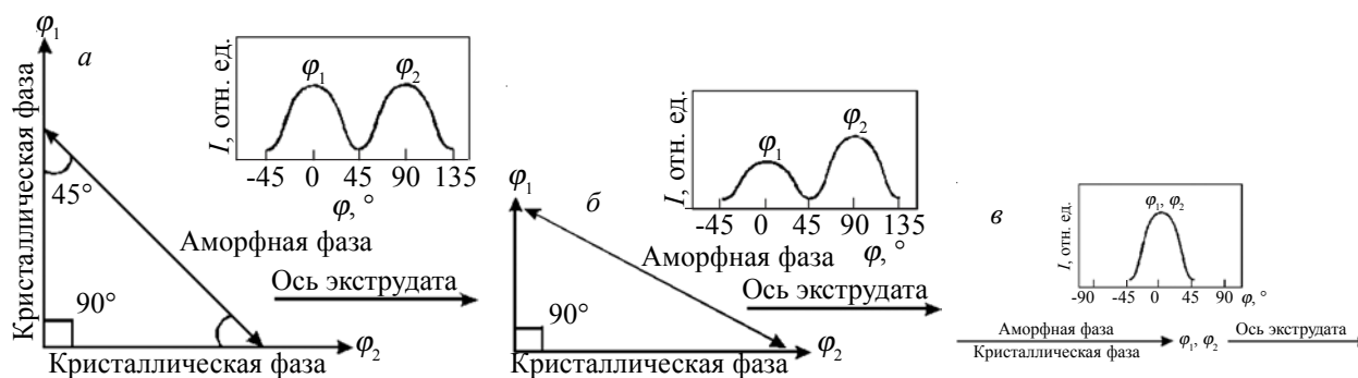
Рис. 4. Схемы направлений преимущественной ориентации АФ и КФ: а – биаксиальная ориентация при равных долях КФ; б – биаксиальная ориентация при неравных долях КФ; в – одноосная ориентация
