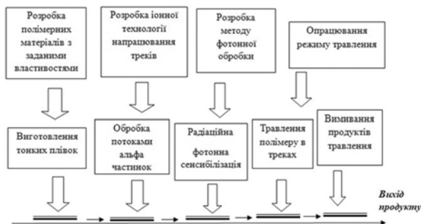
Рис. 6. Технологічний процес розробки технології треккових мембран з поліціануратів
