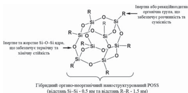
Рис. 8. Схематичне зображення загальної структури наномолекули POSS [70]
