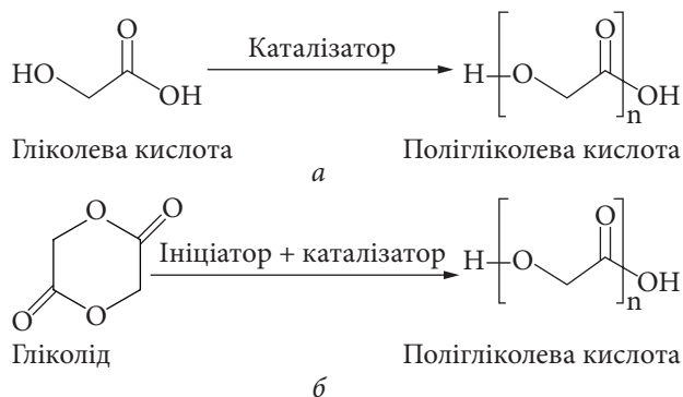
Рис. 5. Схема синтезу ПГК: а — пряма поліконденсація; б — полімеризація гліколіду
